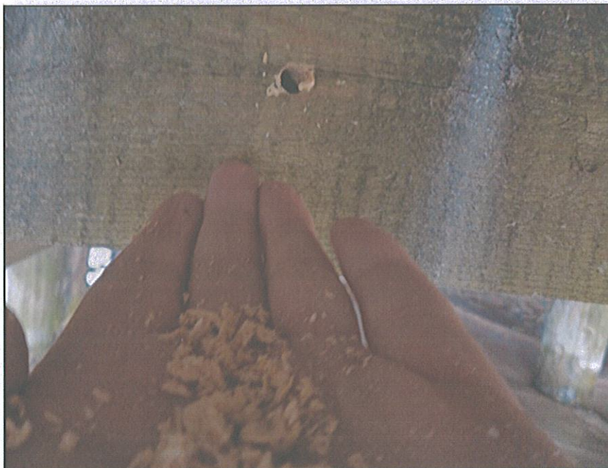
Fot. 7. Odwiert kontrolny w podłużnicy.
